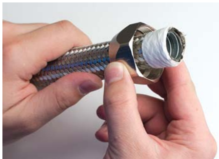
1. Вначале следует одеть на металлорукав зажимную гайку
